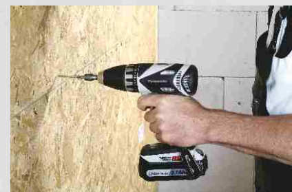
Înșurubează 340 șuruburi în lemn (Ø8 mm x 70 mm)
